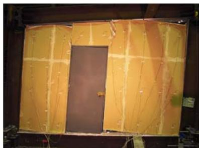
間仕切り壁大変形破壊実験
