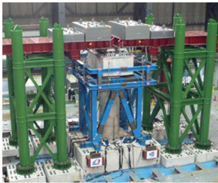
RC橋脚試験体
