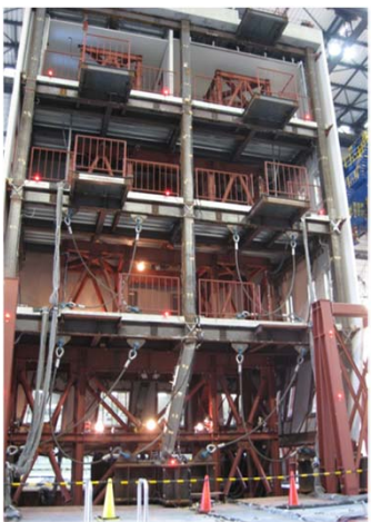
建物の全体崩壊実験(左)と その再現解析(右)
