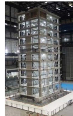
RC造建物試験体
