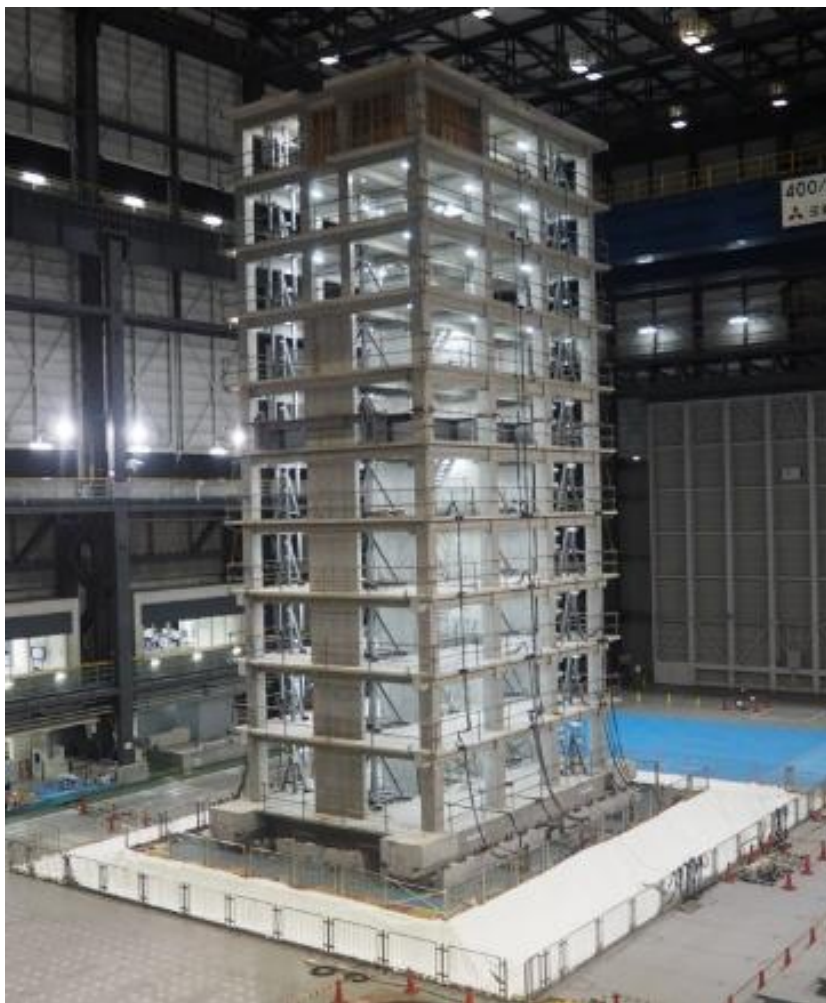
10層RC建物試験体
