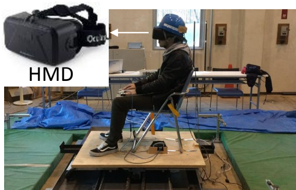
映像と同期した加速度データを用いて加振
