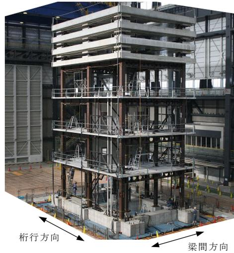
図9 骨組実験システムの全景
