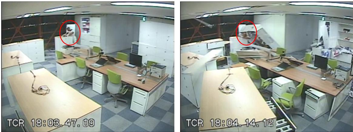
図 66 4階に設置したダミーと室内被害 (JMA 神戸 75 %入力)
