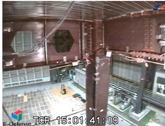
図 14 加振中の柱梁接合部
