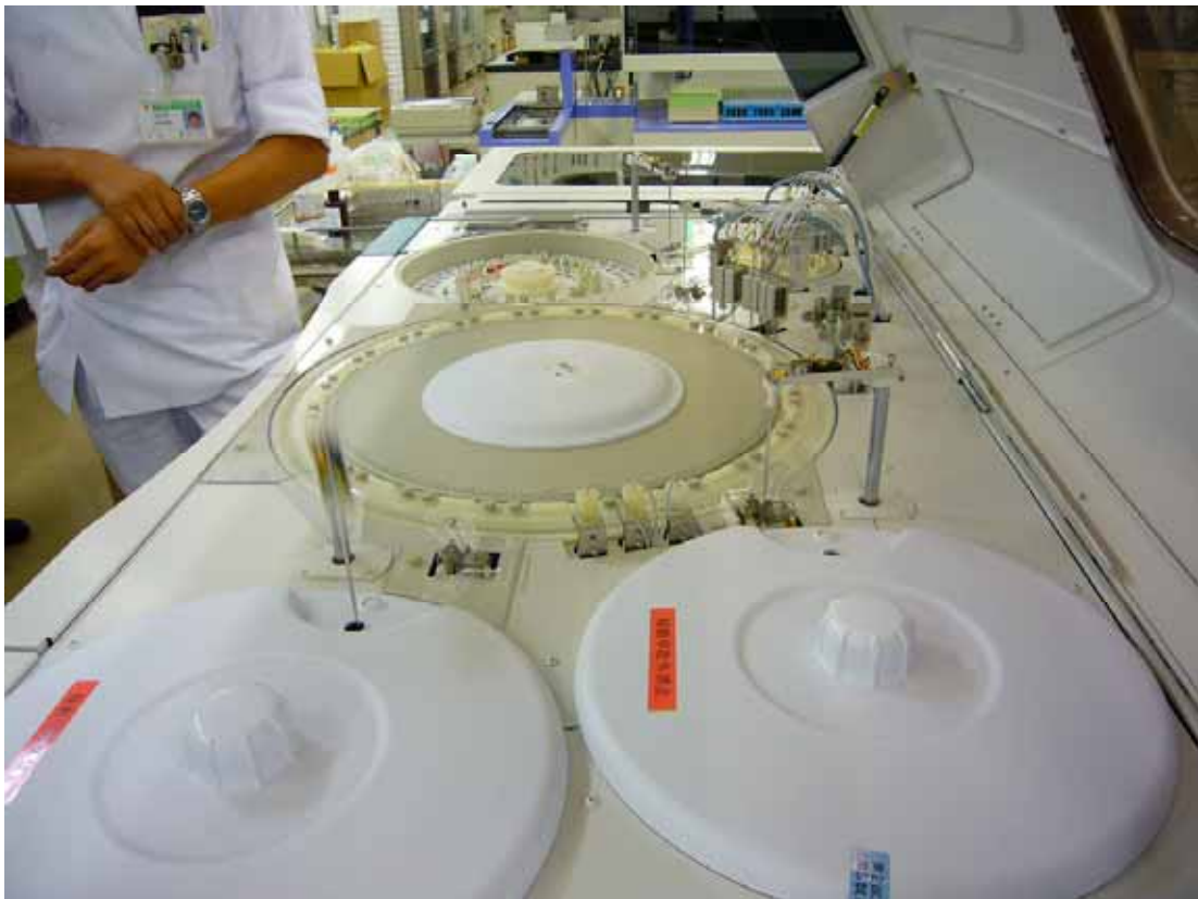
写真5 C病院：生化学自動分析装置：薬液漏れにより故障した
