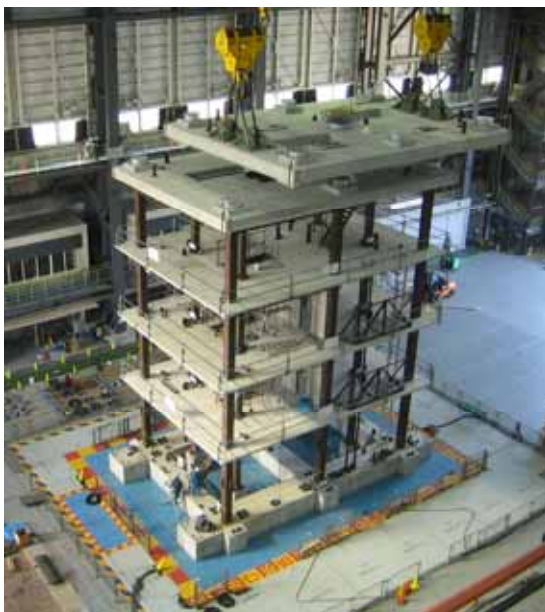
(a) 縮約層の組立状況
