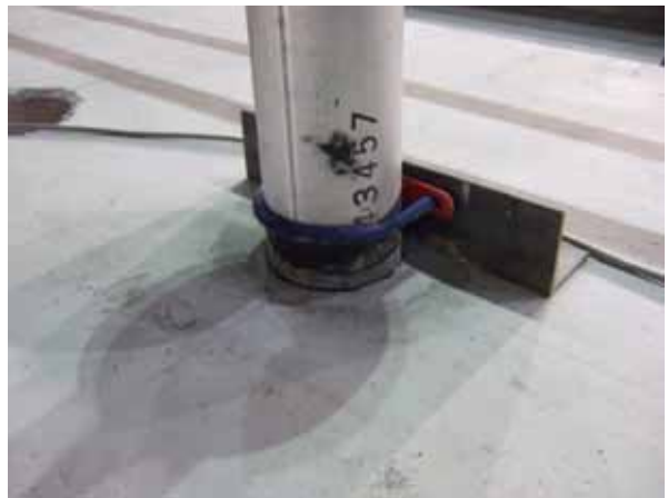
写真 14 100φ SUS 管 (空気圧 0.2Mp) (同左 3,4mm 浮き上がっている)
