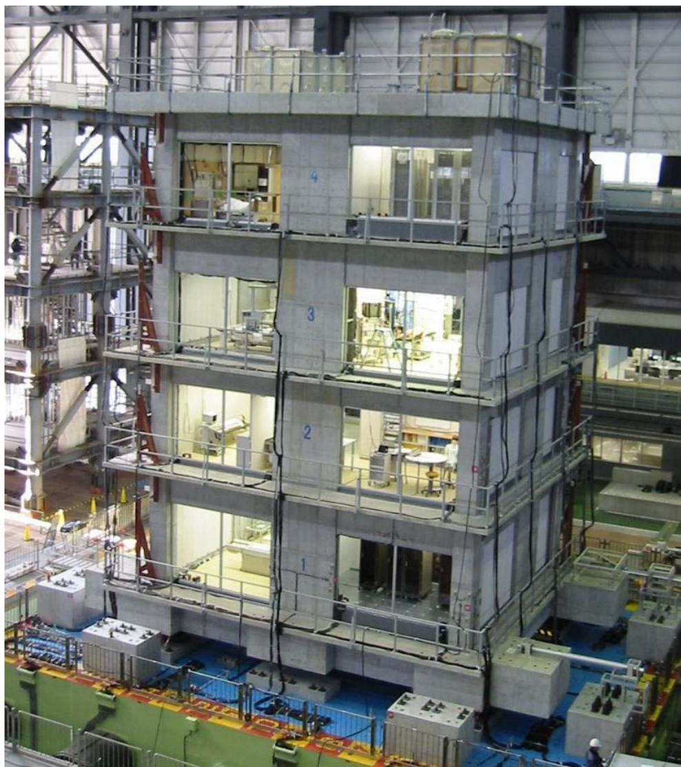
医療施設を模擬した鉄筋コンクリー造試験体建物
