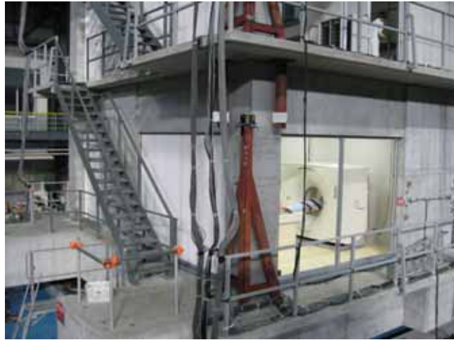
図 2.3 層間変位計測用アングル治具
