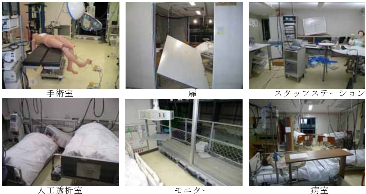
図 10 (a)短周期地震動加振後の室内状況（耐震構造）
