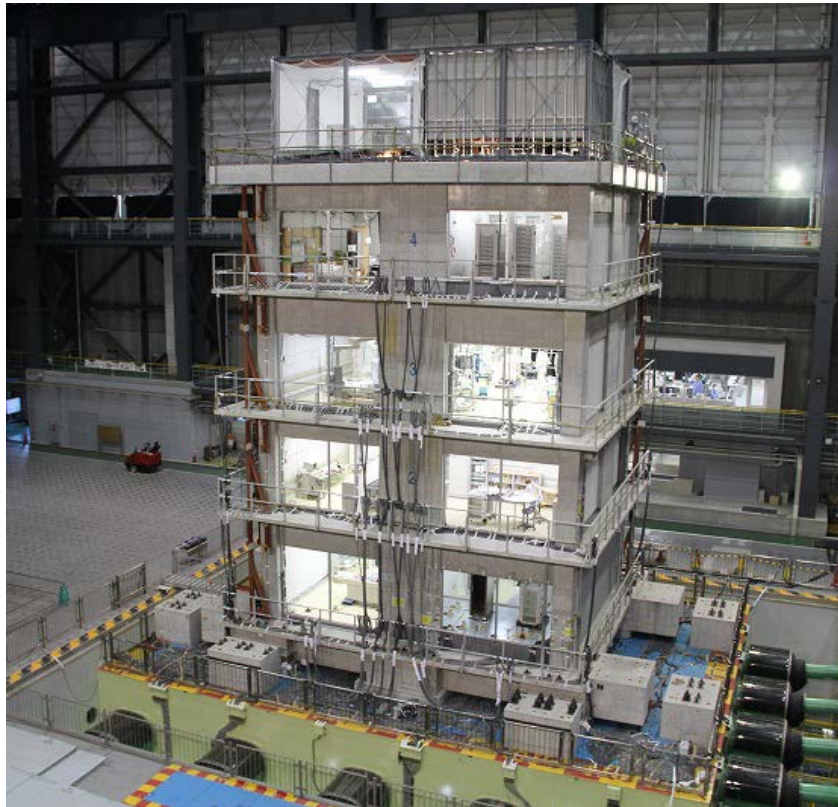
平成 22 年度実験に用いた医療施設を模擬した試験体建物
