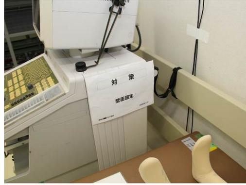
図 72 機器のバンドによる固定
