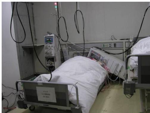
図 47 透析装置がベッド等に衝突により転倒
