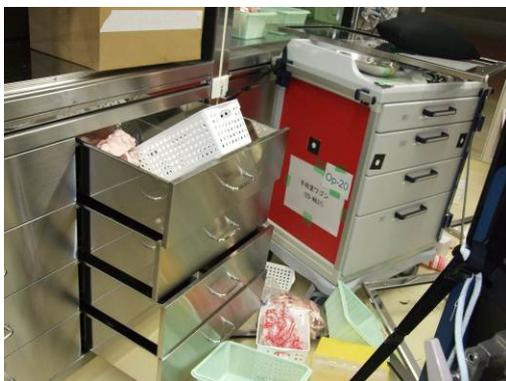
図 38 引き出し飛び出し、内容物が散乱
