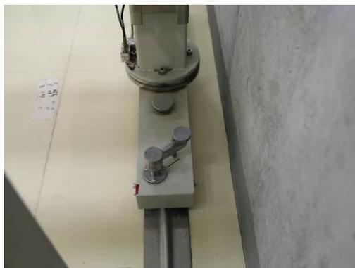
図 61 ストッパーにより固定
