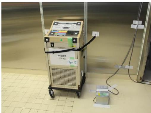
図 42 バンドで壁に固定
