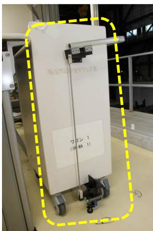
図 88 フェールセーフロック機構の追加
