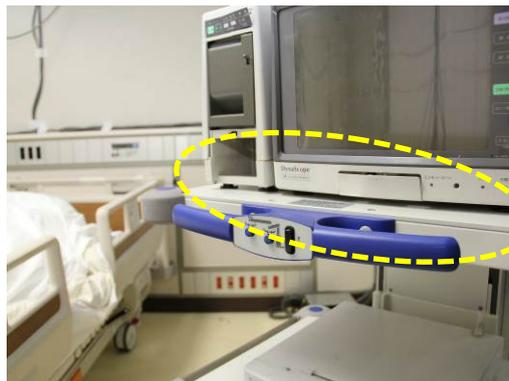
図 91 転落移動に備え、バンドで壁などに固定
