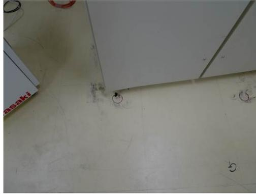
図 59 重量物の移動、アジャスターの破損
