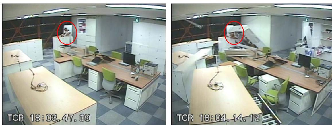
図 66 4 階に設置したダミーと室内被害 (JMA 神戸 75%入力)
