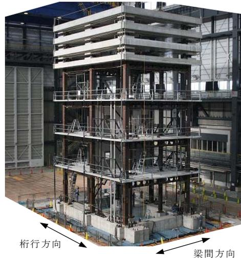
図 9 骨組実験システムの全景
