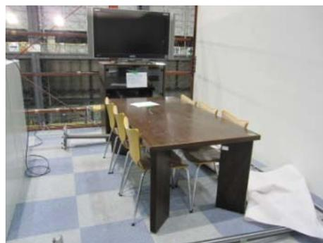
1\_4 西新宿余震 150%の加振後のP1F (パーティションの転倒)
