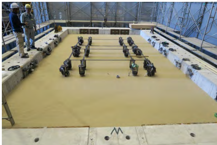
写真2 砂地盤の製作状況
