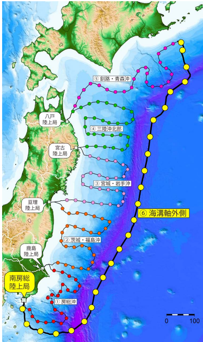
図3 ⑥海溝軸外側（アウターライズ）の海底ケーブルと観測点の敷設予定位置
