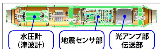
図2 観測装置の外観と内部模式図
