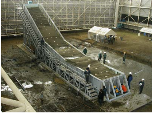
写真2 土砂災害実験例
