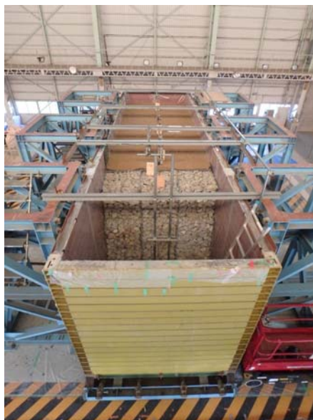
写真-4 土槽全景と蛇籠擁壁
