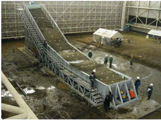
写真2 土砂災害実験例
