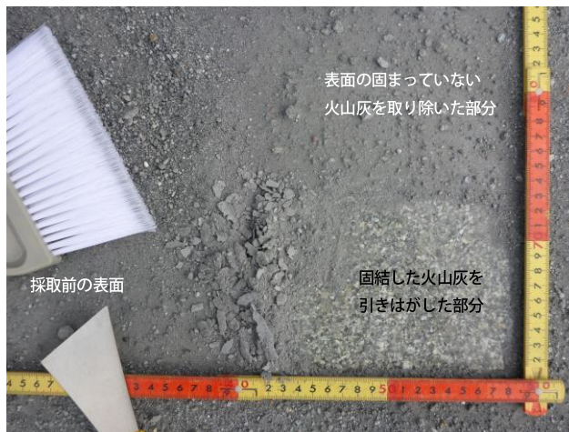
図7:図6と同じ地点。堆積物の下部は固結して張り付いている。
