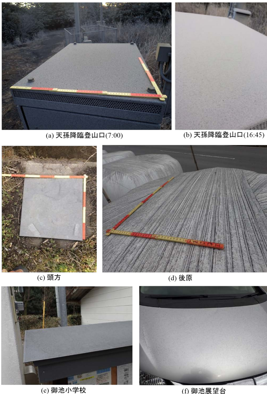
図 1. 調査時の降灰状況. (a) 天孫降臨登山口 (～3/2 7:00). 火口東南東 4.4 km. 降灰量 110 \text{ g/m}^2 . (b) 天孫降臨登山口 (3/2 7:30-16:45). 火口東南東 4.4 km. 降灰量 179 \text{ g/m}^2 . (c) 頭方. 火口東南東 8.2 km. 降灰量 29 \text{ g/m}^2 . (d) 後原. 火口東 7.9 km. 降灰量 18 \text{ g/m}^2 . (e) 御池小学校. 火口東 7.7 km. 降灰量 22 \text{ g/m}^2 . (f) 御池展望台. 火口東南東 9.2 km. 降灰量 6 \text{ g/m}^2 (3/2 15:49-15:58).
