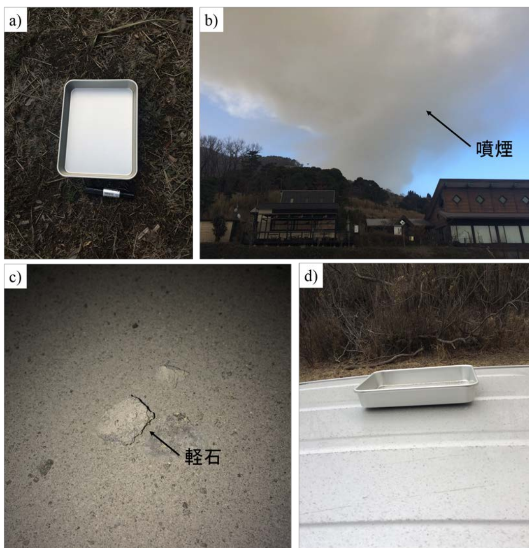
図 1. 噴出物調査の様子. a) 霧島温泉郷(火口から南西に約 6 km)でのトレイを用いた降灰直接採取(3 月 6 日 15:00 頃). b) 火口から南南西に約 6 km のほとと霧島館で観察された噴煙 (3 月 6 日 17:00 頃). c) 火口から西南西に約 3.3 km の新湯入口で観察された粒径約 2 cm 程度の軽石. d) 火口から西に約 4 km の県道一号線沿いで行った降灰直接採取の様子(3 月 7 日 11:00 頃).
