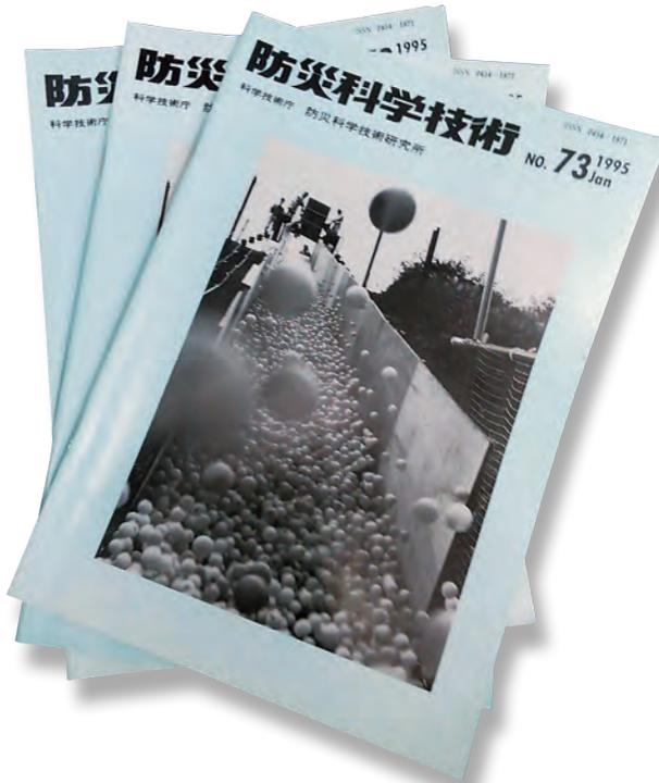
1992年11月14日山形県新庄市で世界初のピンポン球なだれ実験を行いました。傾斜30度、斜面長約20m、流したピンポン球は約7千個。最初に雪崩に巻き込まれる体験をしたのが変身前のDr. ナダレンジャーです。Dr. ナダレンジャーが誕生するきっかけの一つです。写真は1994年9月に新潟県十日町市で行った傾斜40度、斜面長40m、ピンポン球3万個の実験を表紙にした「防災科学技術 No.73 Jan 1995」です。この雑誌、実際に発行されたときの表紙は、ある理由でピンポン球なだれ実験のものではありませんでした。すでに20年以上も前のことです。
