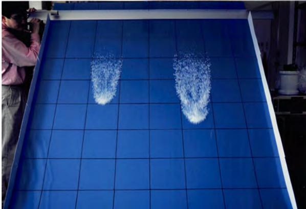
平面上の発泡スチロールなだれ。向かって右の方が左よりも粒子数が2倍。同時にスタートしたが、粒子数が多い方が先頭のスピードは速い。同じ物質であれば粒子数を100万倍にすると速度は10倍程度大きくなる。
