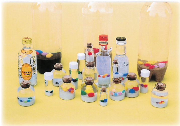
特許第3358178号地盤液状化実験ボトル
