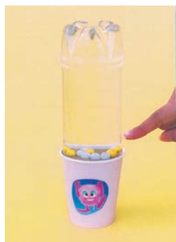
④ここで、ボトルを指先でこつんと1回たたいてみると、沈んでいたマップピンが砂の表面に浮かんでくる。
