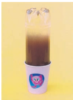
②エッキーをすばやく逆さにし、砂が沈殿するまで振動を与えずにそっとしておく。
