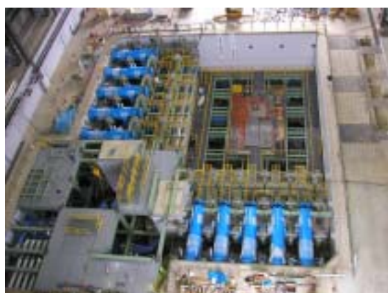
建設中の震動台ピット・加振機と震動台完成予想図
