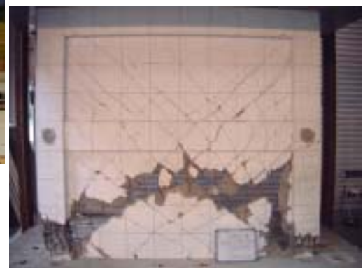
耐震壁単体の振動台実験
