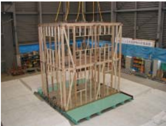
側方流動に対する基礎の破壊メカニズム解明の実験とシミュレーション解析
