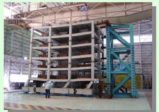
6層耐震壁フレーム構造の振動台実験結果
