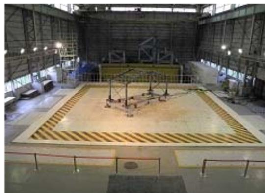
【写真2 縮小模型の振動台への設置】
