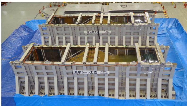
【写真1 加振前の試験体全景（E-ディフェンス震動台上）】
