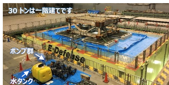
【写真 13 震動台上の試験体（30 トン）】
