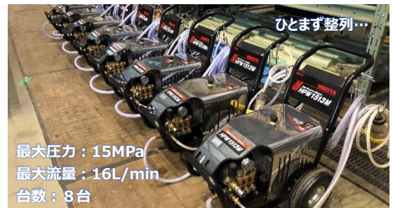
【写真4 60トンを浮揚させる高圧洗浄機】
