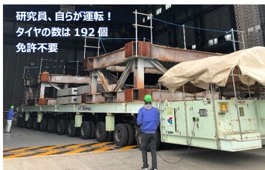
【写真11 900 トンキャリアによる試験体運搬】
