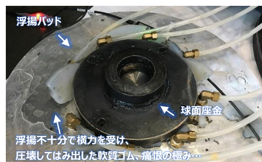
【写真 15 実験終了後の浮揚パッド連結部】
