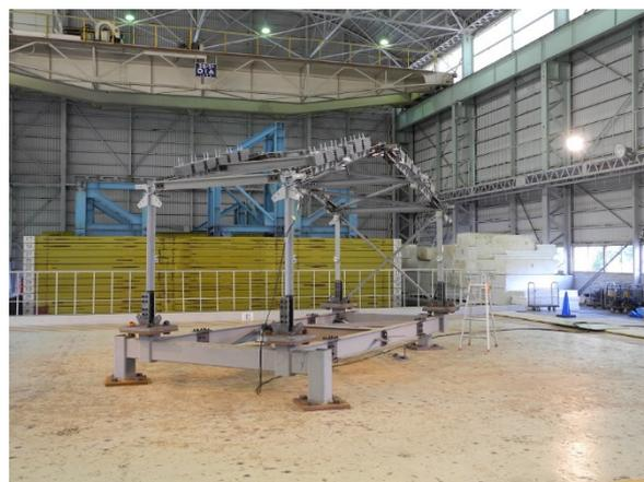
【写真2 壁ブレースの取り外しによる模擬損傷】
