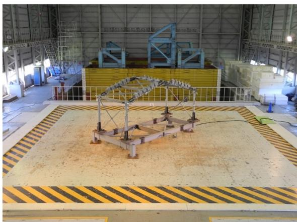
【写真1 振動台上に設置した縮小模型】
