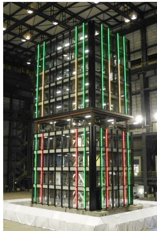
図6 加振後のLED照明の発光
