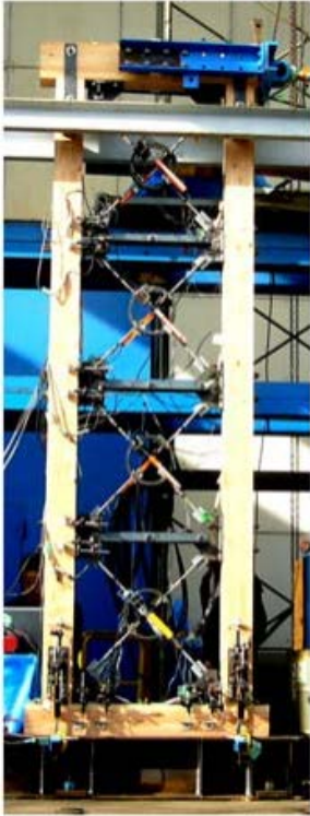
図 4 鉛直フレーム型アウターフレームに用いるリングダンパー
