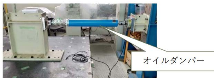
図3 水平ダンパー型アウターフレームに用いるオイルダンパー
