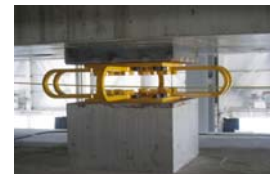
コンクリート錘間の積層ゴムと等価ダンパー
