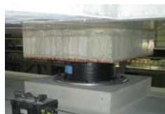
コンクリート錘間の積層ゴムと等価ダンパー
