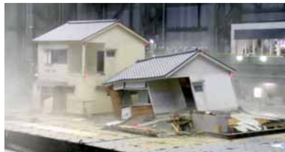
平成 17 年度の震動台倒壊実験
