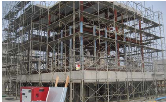
図 2 高層建物の地震応答を再現する試験体
