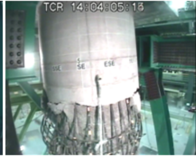
図-2 段落し部せん断破壊の被災状況と実験結果との比較
