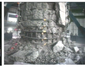
図-1 基部曲げ破壊の被災状況と実験結果との比較
