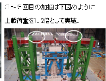
図-1 基部曲げ破壊の被災状況と実験結果との比較
