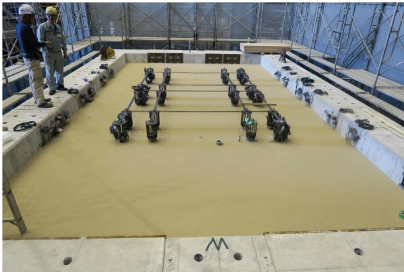
写真2 砂地盤の製作状況
