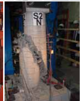
段落し部せん断破壊タイプ
