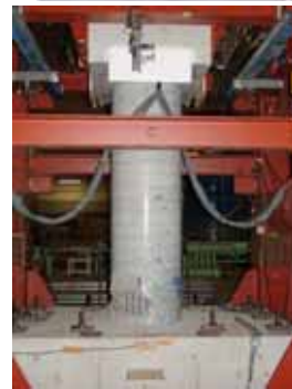
橋脚基部曲げ破壊タイプ
