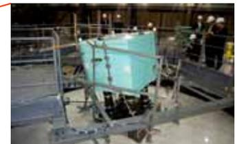
最も大きな加振により傾いた上部構造物
