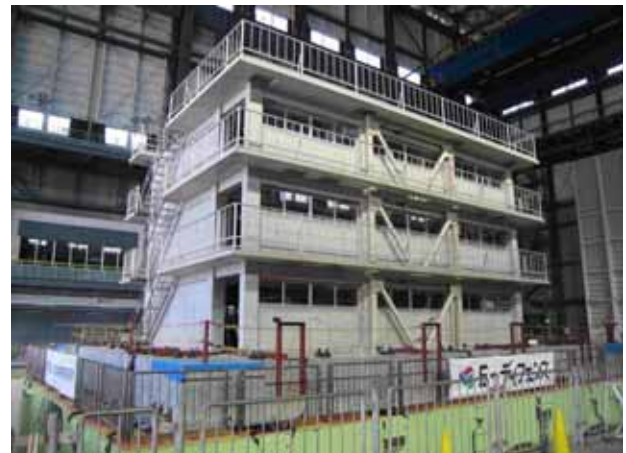
耐震補強試験体
