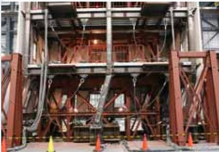
崩壊した試験体1階部分
