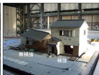
耐震補強のない試験体のみ倒壊
