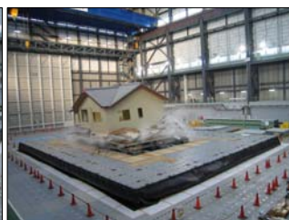
E-ディフェンス上の試験体(震災復旧実験)
