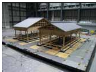
屋根形式の違いを比較する試験体
