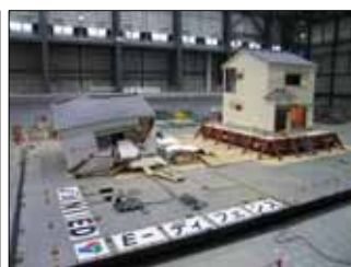
E-ディフェンス上の試験体(C棟のみ倒壊後)
