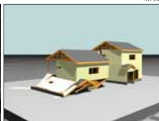
試験体の倒壊挙動(解析アニメーション)
