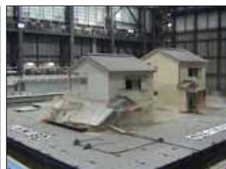
試験体の倒壊挙動(平成17年度実験)
