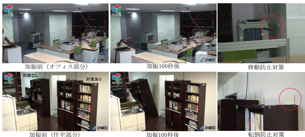
写真 6 上層階部分の室内の状況 (西新宿 330%波入力時)
