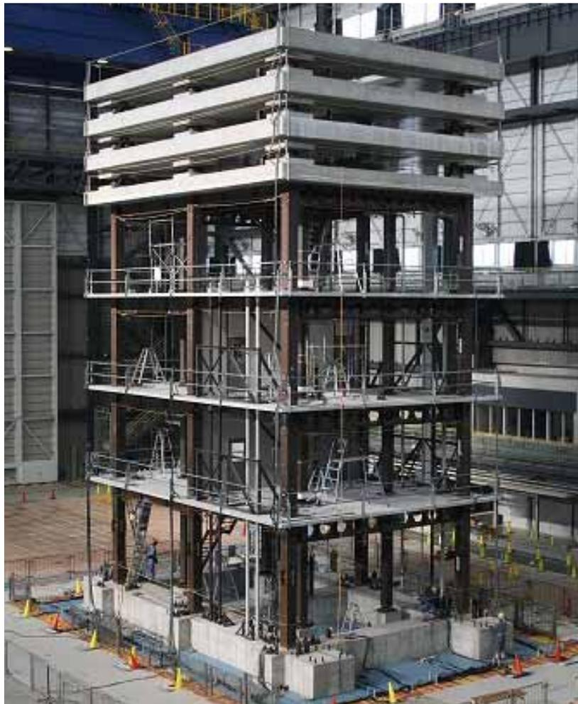
震動台上に設置した試験体
