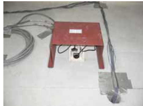
写真2 縮約層加速度センサ
