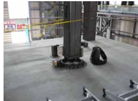
写真4 縮約層変位センサ
