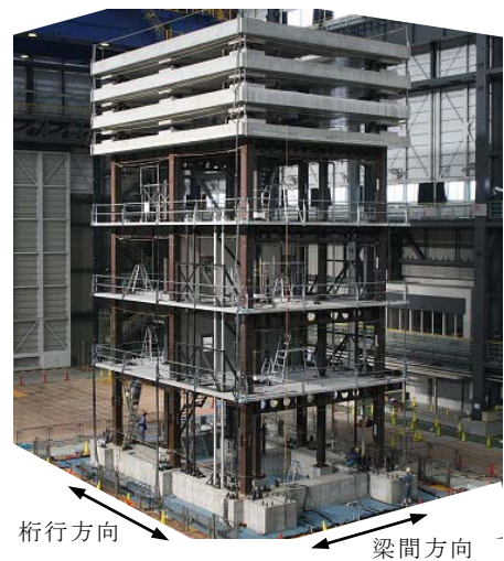
図 7 振動台上の試験体全景
