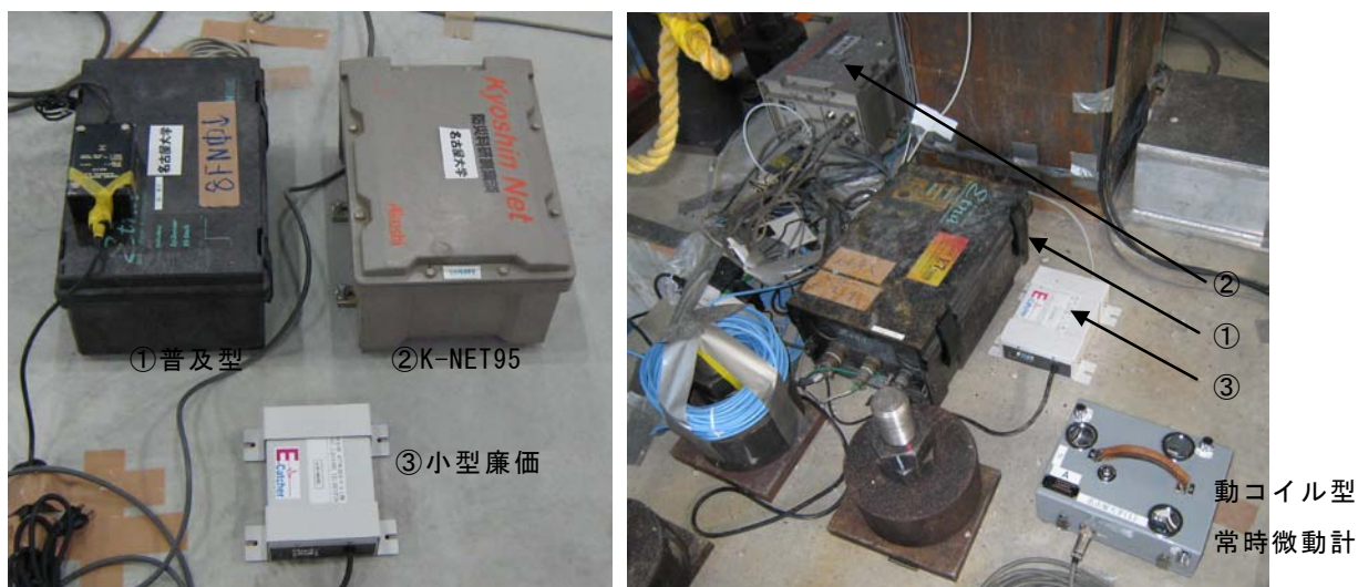
写真1 使用した3種の強震計（左：8階中央、右：1階北）
