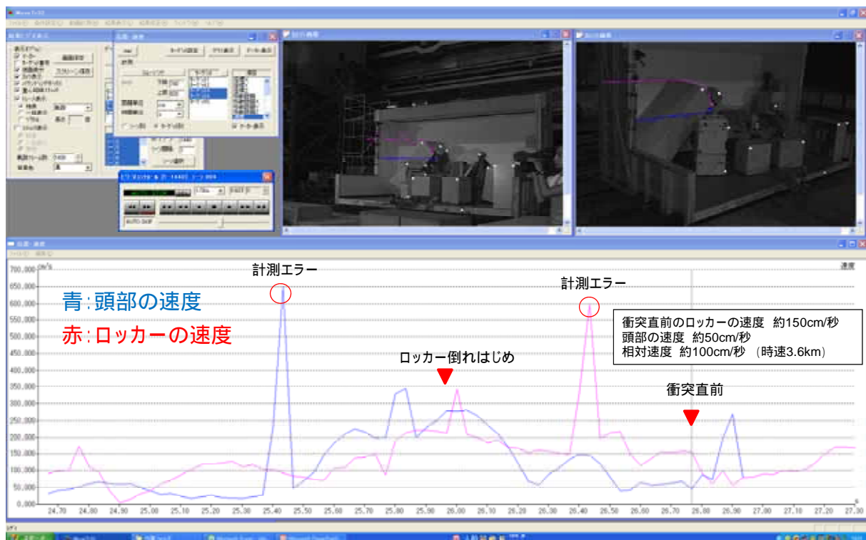
図8 ロッカー棚とダミー人形頭部の速度計測
