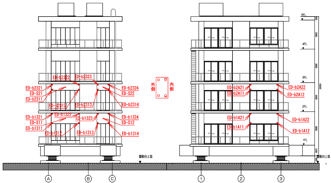
梁部埋設 歪ゲージ
