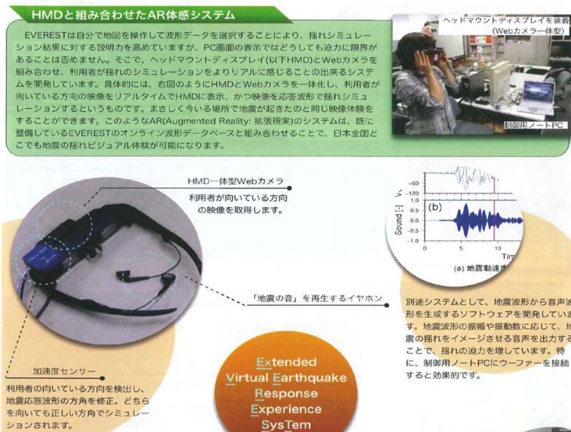
図 13 ヘッドマウントディスプレイ (HMD) を用いた体験システムの概要
